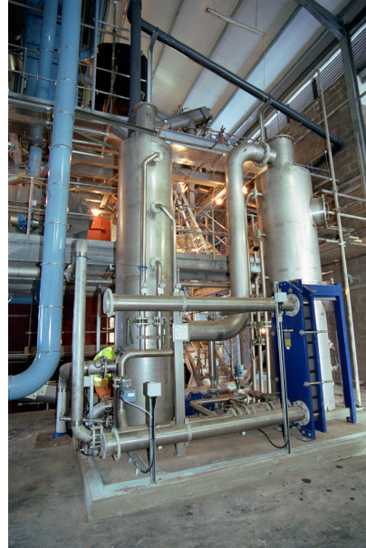
Tweetraps koeler / condensor
