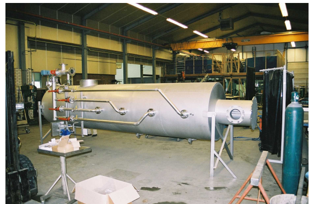
Koeler/condensor in productie
