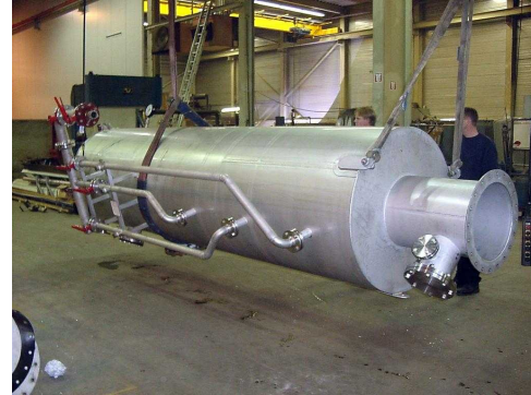
Koeler/condensor in productie
